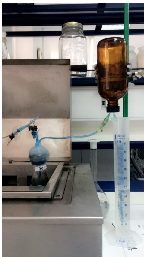
Εικόνα Β.15 – Βύθιση αντιδραστών σε υδατόλουτρο και ογκομέτρηση μεθανίου με διάλυμα ΚΟΗ.
