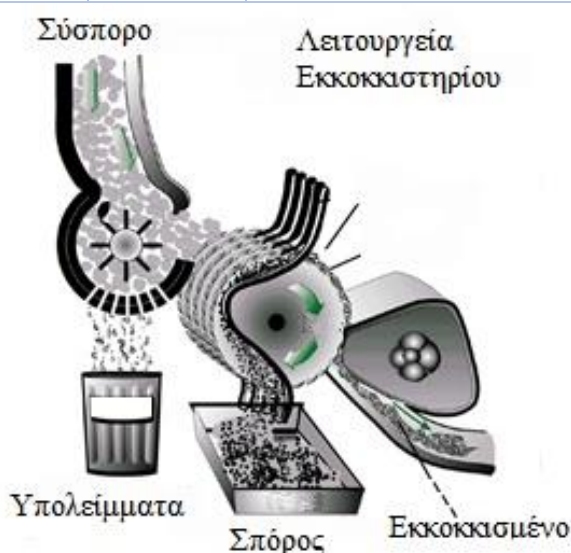
Σχήμα 1.5 : Λειτουργία εκκοκκιστηρίου, διαχωρισμός βαμβακιού (www.michas-levcot.com).
