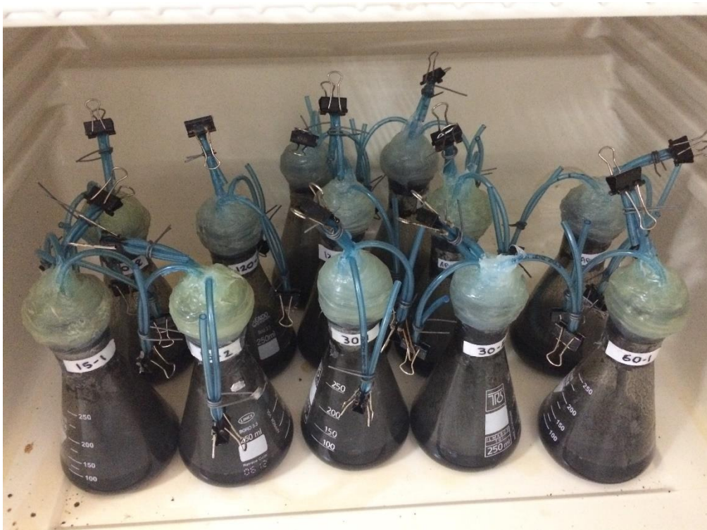
Εικόνα Β.14 – Αναερόβια χώνευση των αντιδραστών εντός του επωαστήρα σε θερμοκρασία 35° C
