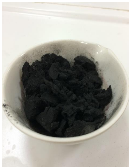
Εικόνα Β.17 – Απομάκρυνση της τέφρας μετά τον κλίβανο
